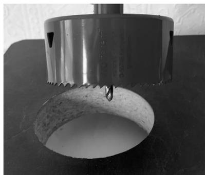
Lochsäge mit  $\varnothing$  105mm
