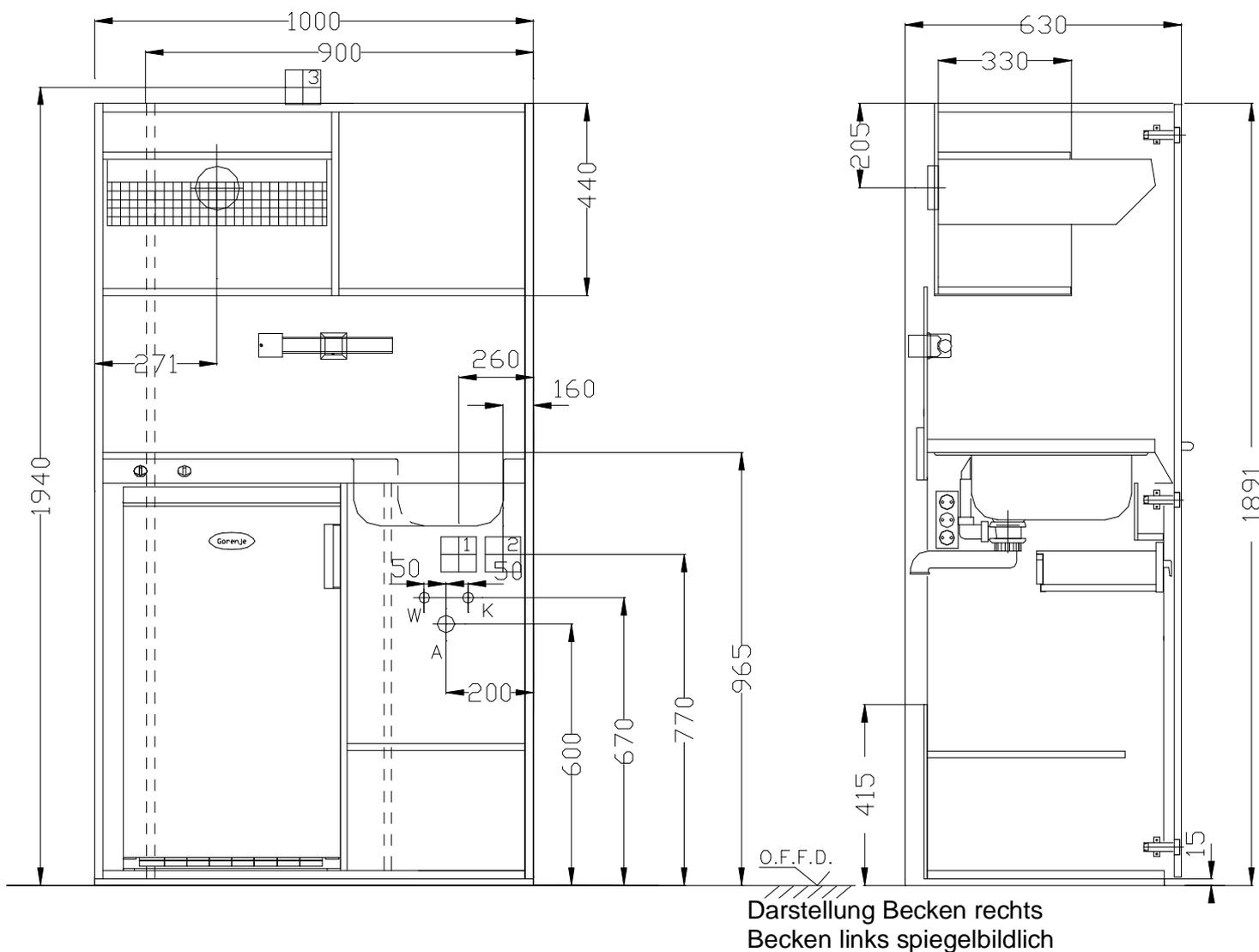
K – Kaltwasseranschluss ½“ Eckventil
