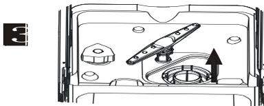
Schritt 3: Feinfilter anheben
