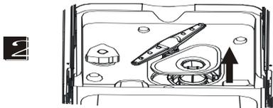
Schritt 2: Hauptfilter anheben
