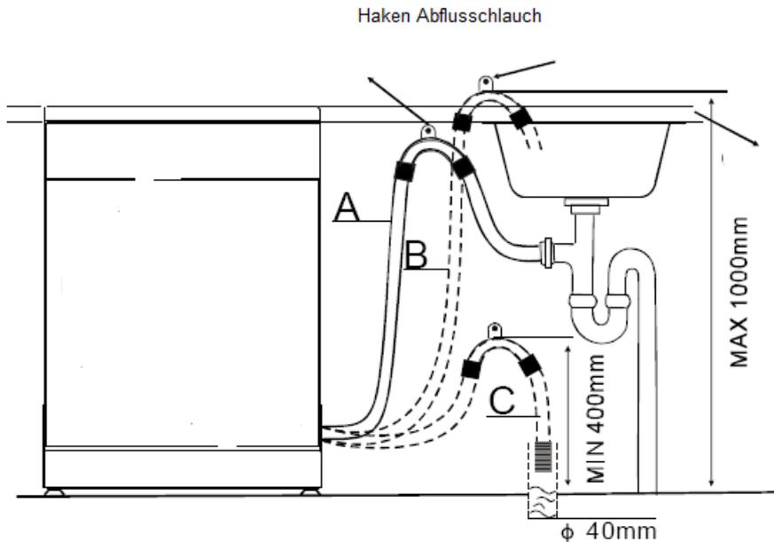
Den Ablaufschlauch anschliessen. Der Schlauch muss einwandfrei befestigt werden, damit kein Wasser herausläuft, er darf weder geknickt noch eingeklemmt werden.
