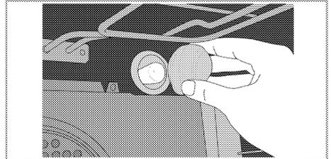
3. Drehen Sie die Lampe gegen den Uhrzeigersinn heraus, setzen Sie eine neue Lampe ein.
