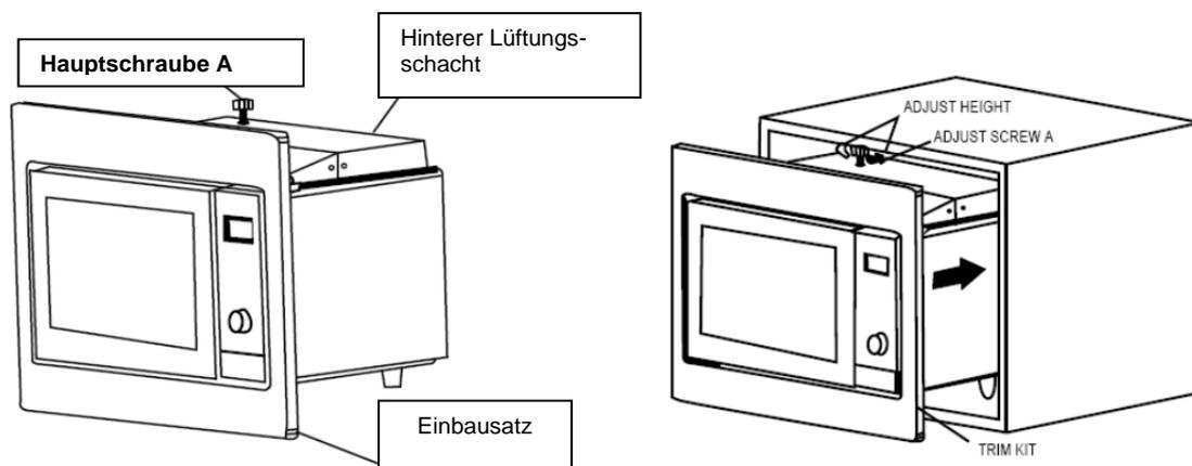
1. Fixieren Sie die Hauptschraube A, anschließend installieren Sie die Mikrowelle. Das Netzkabel darf nicht geknickt werden. Lassen Sie 1mm frei zwischen der Hauptschraube A und der oberen Begrenzung der Einbaunische. Stellen Sie sicher dass der Ofen in der Mitte des Gehäuses installiert ist.
