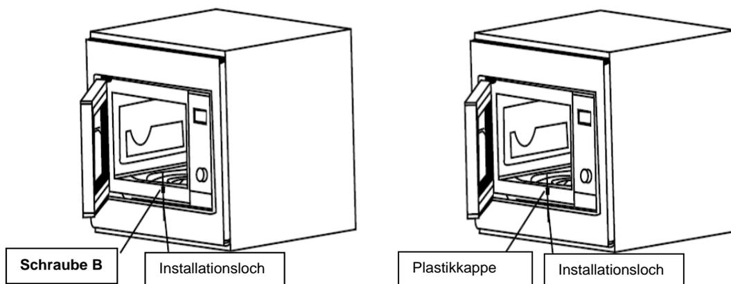
2. Öffnen Sie die Tür und fixieren Sie das Gehäuse indem Sie die Schraube B in das Installationsloch des Einbausatzes schrauben. Anschließend bringen Sie die Plastik- kappe des Einbausatzes an.
