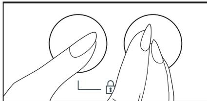
**i** Wenn die Kindersicherung eingeschaltet ist, blinkt eine LED der Programmfolgeanzeige.
