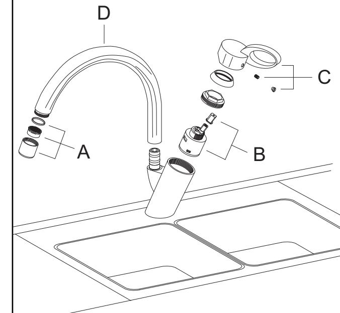
Particolari di ricambio disponibili - Spare parts available - Ersatzteile verfügbar - Pièces détachées - Repuestos disponibles
