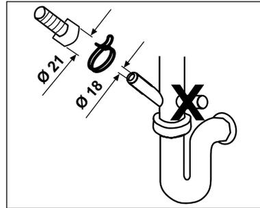
Wasserablaufschläuche mit einer Länge von mehr als 4 m können zu Verschmutzungen führen. Achten Sie darauf, dass der Wasserablaufschlauch auf dem Weg zum Ablauf nicht geknickt oder stark gebogen wird. Fixieren Sie den Wasserablaufschlauch so am Ablauf, dass er sich im laufenden Betrieb des Gerätes keinesfalls lösen kann.
