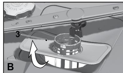
3. Drücken Sie die beiden Sperren am Grobfilter nach innen, lösen Sie den Grobfilter von der Baugruppe (C).
