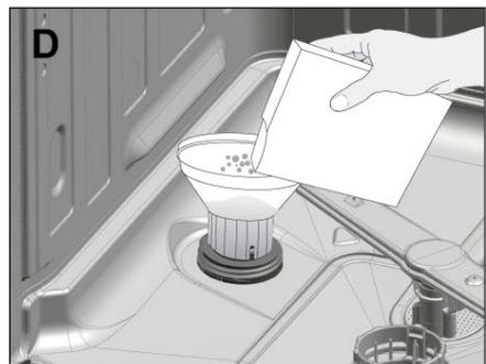
5. Lassen Sie das Gerät anschließend einmal leer arbeiten (kürzestes Programm); so löst sich das Salz schneller auf, außerdem werden Salzreste aus dem Gerät entfernt.
