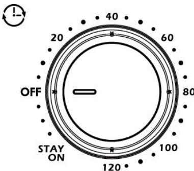
Réglez la durée souhaitée dans le sens des aiguilles d'une montre, le voyant de contrôle s'allume
