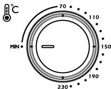
Per la regolazione della temperatura di cottura, non per spegnere l'apparecchio.
