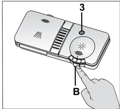
2. Füllen Sie den Behälter bis zur MAX-Markierung.
