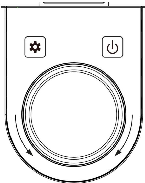
Drehregler: Einstellung der Stunden und Minuten für Uhrzeit und Timer
