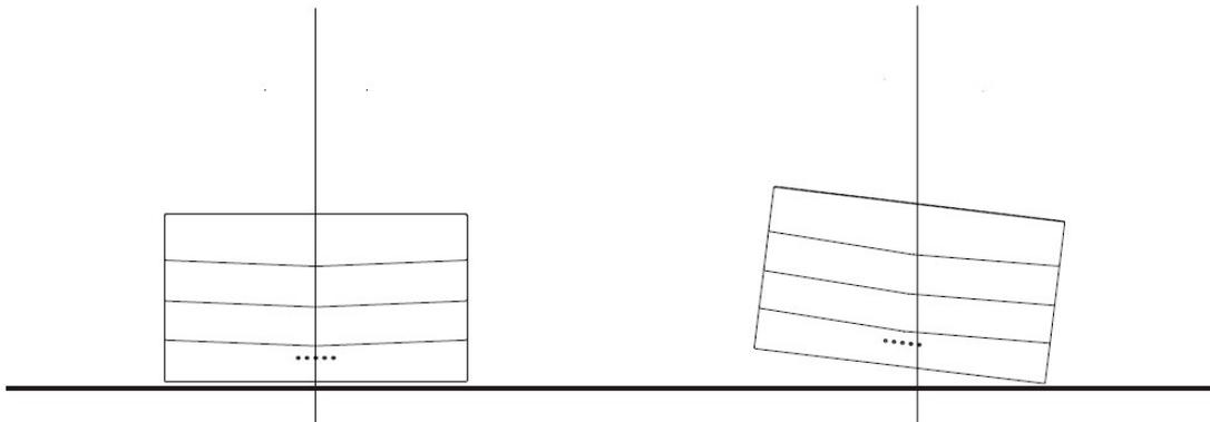
Führen Sie den Einbau des Geräts mit **mindestens zwei Personen** durch, weil Sie ansonsten das Gerät beschädigen oder der Person, die an dem Gerät arbeitet, Schaden zufügen.
