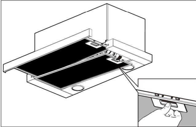
3. Die Kohlefilter werden auf beiden Seiten auf den Motor der Haube gesteckt und durch eine Drehbewegung befestigt (Bajonettverschluss). Befestigen Sie die Fettfilter wieder. Die Saugleistung wird durch die Kohlefilter vermindert.
