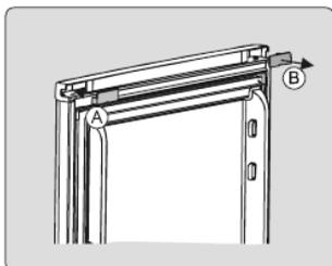
Die Schraube von dem Tür Stopper lösen und den Türstopper entfernen. Den Türstopper auf der anderen Seite der Gerätetür fixieren (entsprechend dem Türwechsel).
