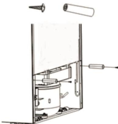
Zur Einhaltung der Abstände und zur Erreichung der angegebenen Energieklasse sind die beigegefügte Abstandshalter am Gerät anzubringen. Sie werden direkt hinten am Gerät fixiert (siehe Zeichnung Fig.3).
