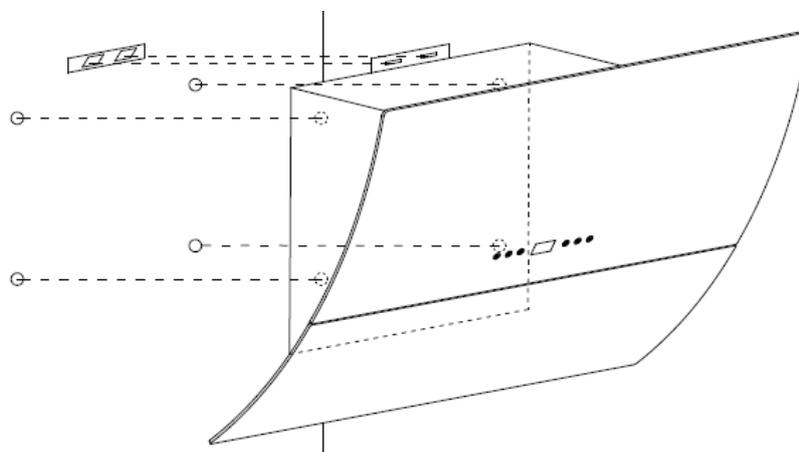
Überprüfen Sie, ob Ihr Gerät aus der Front- und Seitenperspektive gerade und waagrecht an der Wand angebracht ist, da das Gerät ansonsten nicht ordnungsgemäß arbeitet.
