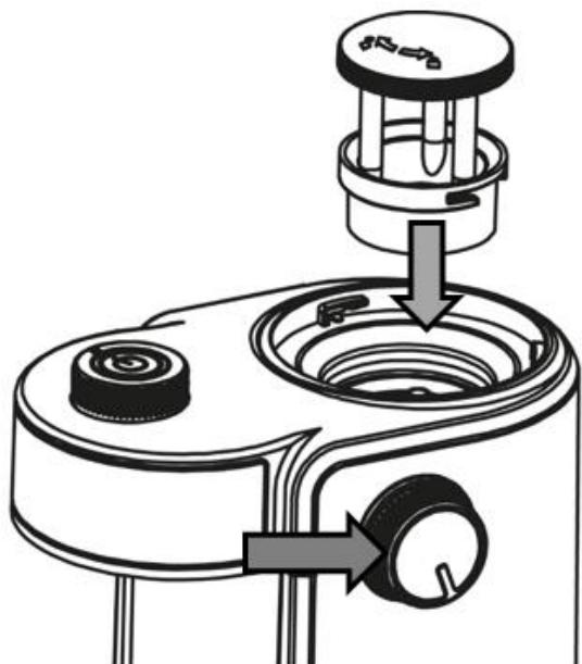
Apoyar el mecanismo de molienda y girarlo suavemente de un lado a otro hasta que se deslice hacia el interior, dentro de la guía.
