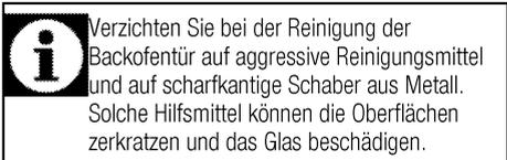
Verzichten Sie bei der Reinigung der Backofentür auf aggressive Reinigungsmittel und auf scharfkantige Schaber aus Metall. Solche Hilfsmittel können die Oberflächen zerkratzen und das Glas beschädigen.
