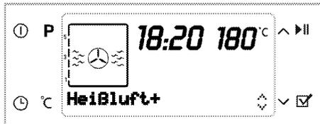
Bei geöffneter Backofentür schaltet sich der Lüfter ab, damit die heiße Luft im Inneren verbleibt.
