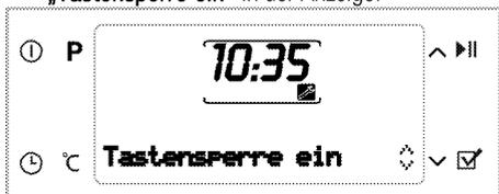
» Bei aktiver Tastensperre leuchtet die Meldung „Tastensperre aktiv“ auf, wenn Tasten betätigt werden (mit Ausnahme von ).
